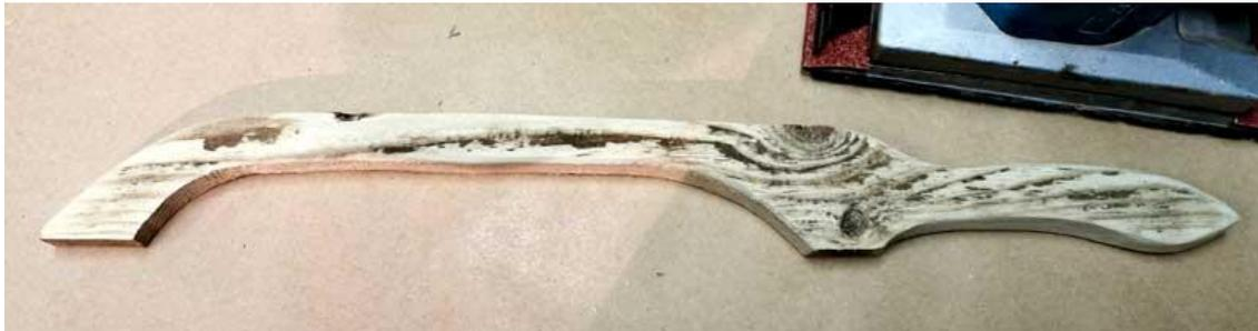
Nach der Behandlung mit dem Schwingschleifer wird noch mit sehr feinem Schleifpapier nachgearbeitet. So entsteht eine sehr angenehme, fast weiche Oberfläche. Das untere Bild zeigt nun die fertig geschliffene Form der Brotsäge.
