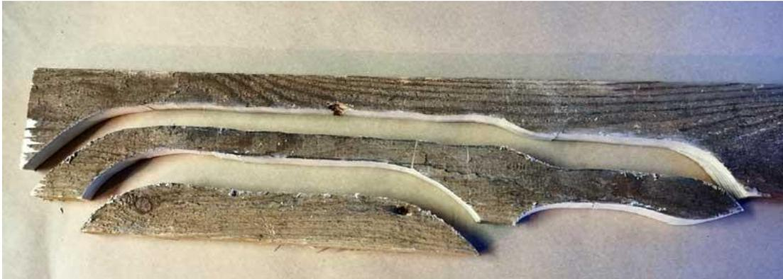
Aus dem Brett wird mit einer Stichsäge die Form ausgesägt.
